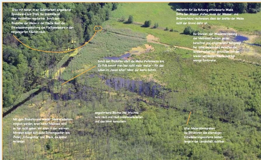
Stau mit fester, in ein Schotterbett eingebauter Spundwand aus Stahl. Die Stauhöhe ist über Holzballen regulierbar. Durch den Rückstau der Welse in der Fläche lässt die Entwässerungsleistung des Fließgewässers in den vorgelagerten Flächen nach.
